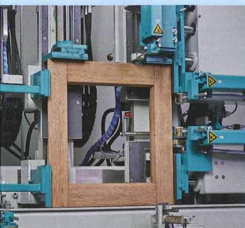
Kleinstmasszulagen zum Verpressen von Rahmen bis ca. 380 x 380 mm accessory set for minimum sizes for pressing frames to approx. 380 x 380 mm
