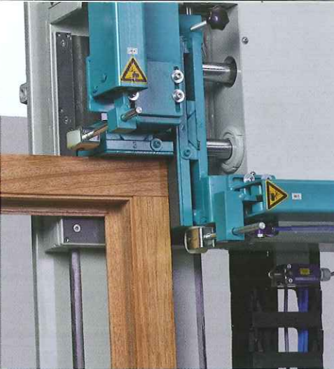
Zwangsgeführte rechte obere Pressecke verhindert Zylinderkollisionen captive upper right press unit prevents cylinder collisions
