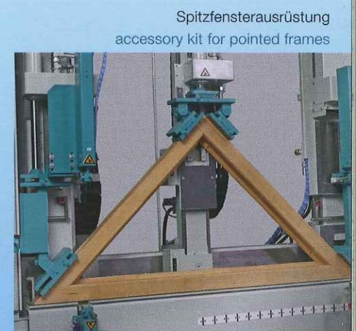
Rahmenverbreiterung oben und unten mit automatischer Hochschleppfunktion extended width at top and bottom with automatic hauling function
