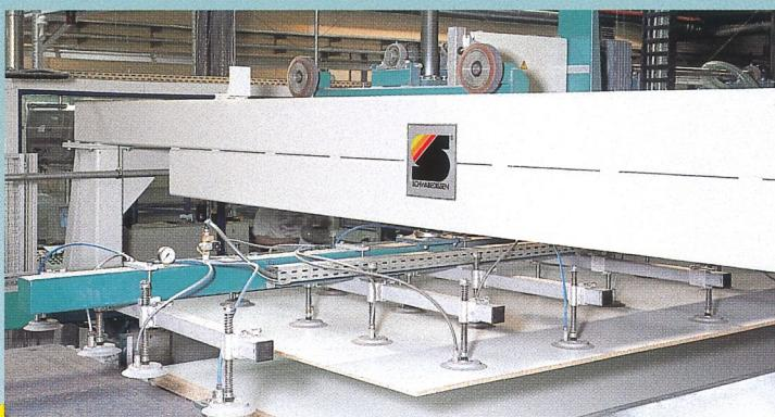
Das Plattenpaket wird vor dem Schnitt an allen vier Seiten ausgerichtet.
