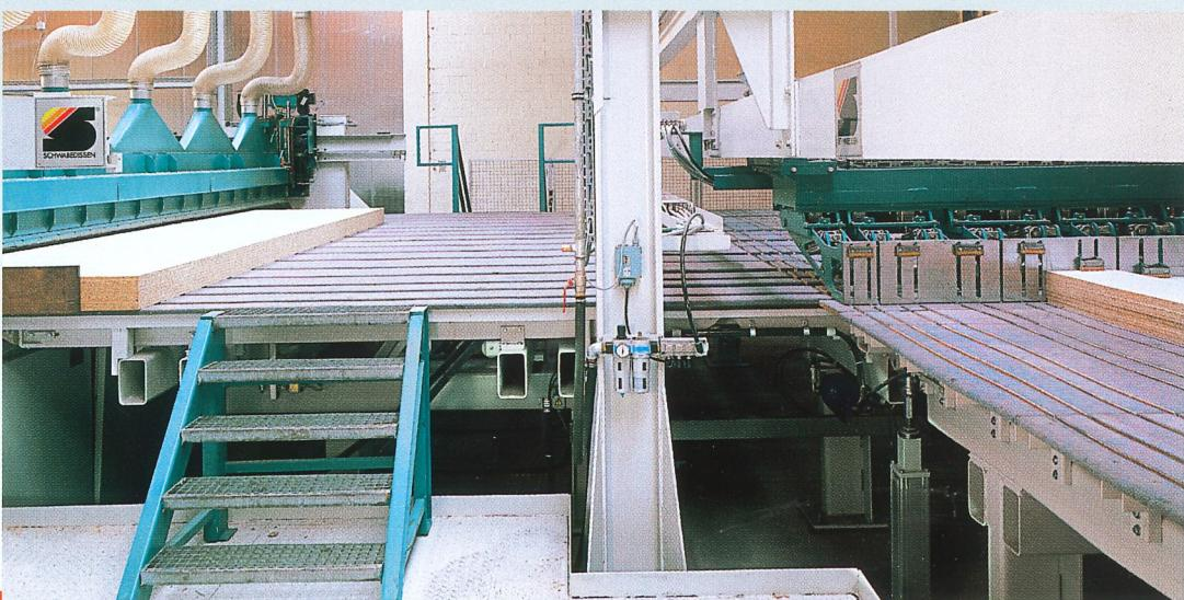
Die auftragsgerechte Zuordnung der Fixmaße erfolgt durch Stapelsysteme, z.B. die Schwerterwagenstapelung für Großformate ...
