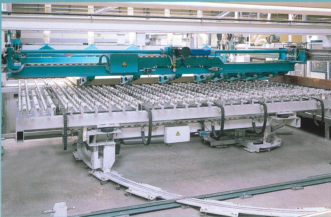
Wahlweiser Einsatz eines Dreh-tisches für Zuschnittprogramme mit geringem Anteil von Kopf-schnitten.
