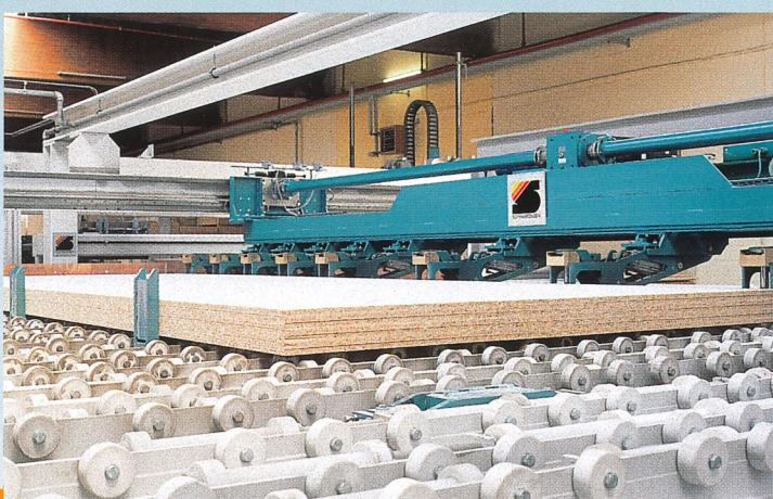
Die abgebildete Winkelanordnung ist typisch für eine Fixmaßauftteil-anlage und gewährleistet einen kurzen, rationalen Transportweg.
