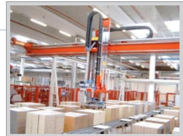
Die Rahmenkonstruktion wird durch den Saugrahmen aufgenommen. Die Paletthaltefinger sind zentrisch drehbar angeordnet. Die Rollenbahn bildet die Verbindung zwischen der Systraplan Anlage und der nachfolgenden Bearbeitungsmaschine. Als leistungsstarkes und flexibles Unternehmen können wir jede Anlage individuell den Anforderungen des Anwenders anpassen.
