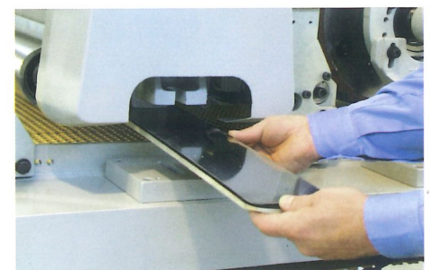
Sostituzione rapida lamina con feltro Quick substitution lamina with felt Schneller Wechsel der Gleit- und Schleifbeläge
