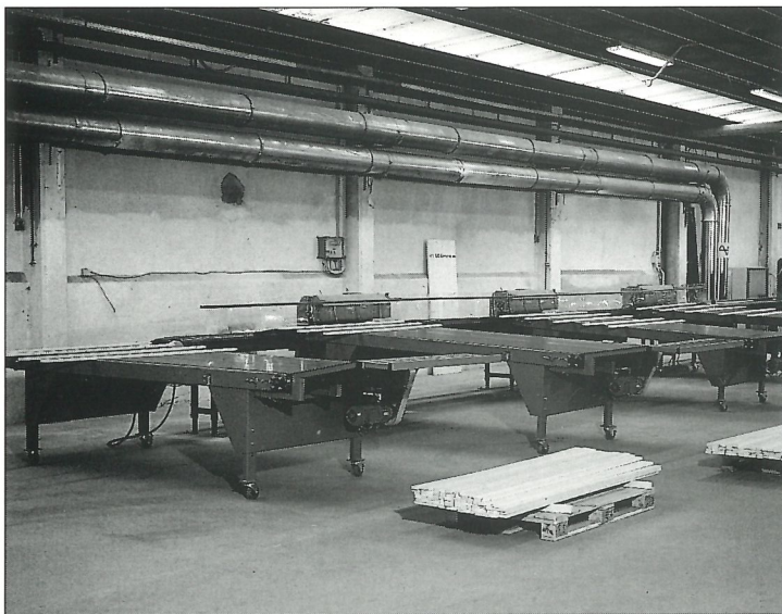
Med HAWKEYE farve-skanner baserede sorteranlæg er en fuldstændig ensartet kvalitetssortering af lamellerne nu en realitet.
