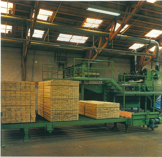
Stablende for tværafkorteranlæg
