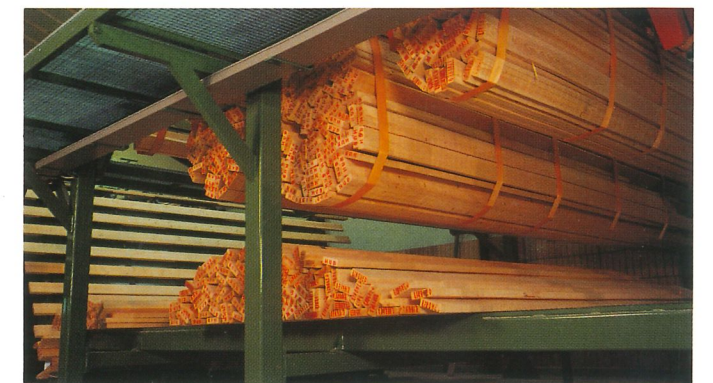
Sorterbokse i enkel og kraftig udførelse - ingen faldhøjde ved tømning - automatisk tømning og genladning.
