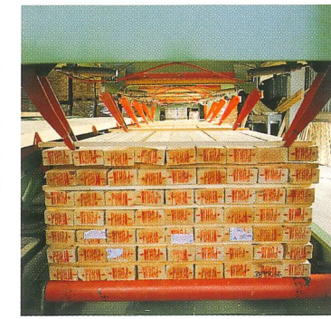
Automatisk strølegging, strøene styres på plass av to metalstyringer som legger strøene nøyaktig overfor hverandre. Dette forhindrer at emnet blir skadet.
