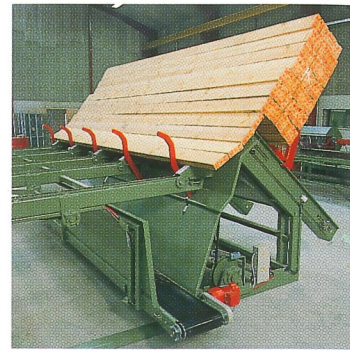
Alle våre Op/ned anlegg kan levere med motholdssystem på tilten, dette reduserer kantskader og gir støysvak drift.
