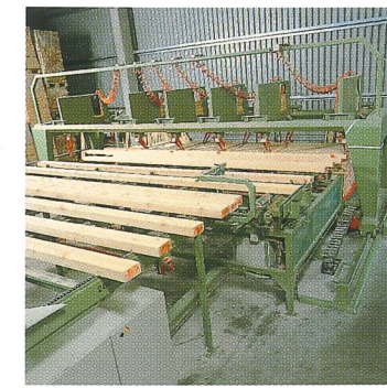
Stablesiden på Op/ned 125/200. Stablesikkerhet og presis strølegging har fått høyeste prioritet.
