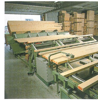
Innmatningsiden på Op/ned 125/200. Vi har utviklet detaljløsninger som minimerer støy og kantskader. Myndighetenes krav om støygrenser etterleves fullt ut.
