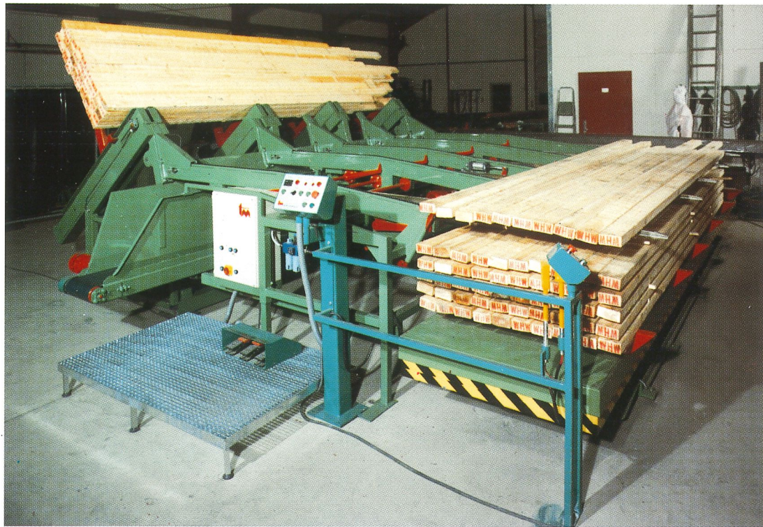
Alle våre Op/ned anlegg kan levere med motholdssystem på tilten, dette reduserer kantskader og gir støysvak drift.
