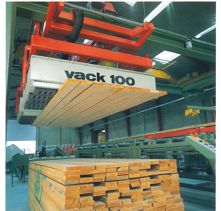
Vacuum-planet på Vack 100 har falskluftventiler. De lukker automatisk hvis treet ikke har full kontakt. Vack 100 kan løfte opp til 350 kg pr. lag.
