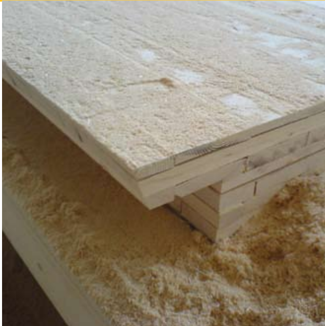
coupe en biais et feuillure à la scie avec la TW-Mill
