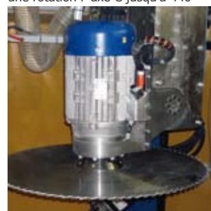
scie sans bride pivotante jusqu'à 92°
