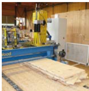
TW-Fix – le portique de perçage et de chevillage
