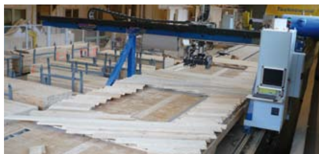
élément mural avec grand espace réservé aux fenêtres
