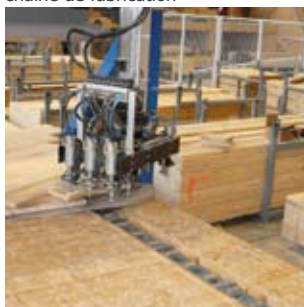
TW-Layer – le portique de pose
