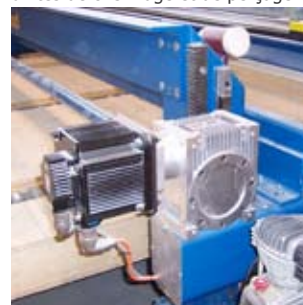
grande moteur (Gantry) pour générer le tension de serrage
