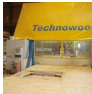
TW-Mill - le portique d'assemblage
