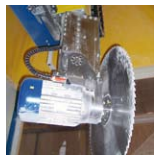
une rotation l'axe C jusqu'à 440°
