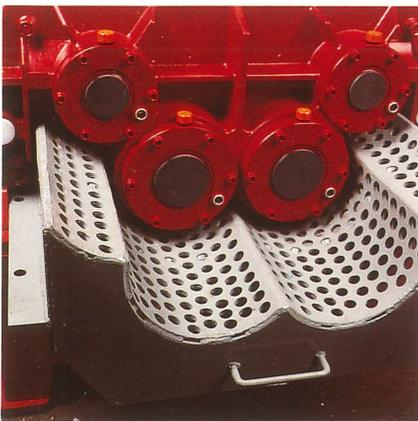
● Das - auf Rollen ausfahrbare - Lochgitter ermöglicht ein einfaches Reinigen und einen schnellen Siebwechsel (bei verschiedenen Lochgitter-Durchmessern) zur Änderung der Granulatgröße.
