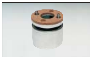
Bodendrehvorrichtung, dient zum Drehen der Last um 360 Grad, ohne die Steuerungseinheit zu bewegen. Besonders hilfreich zum Beispiel beim Stapeln von Kartons auf einer Palette in einem bestimmten Muster.
