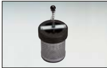
Schutzventil für das sichere Heben mit feststehenden Haken/Hilfsmitteln. Aufgesetzt zwischen dem Hubschlauch und Saugkopf, beseitigt sofort den Unterdruck in der Heberöhre, sollten die Güter versehentlich ausgeklinkt werden.
