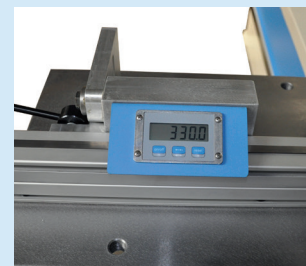
Digital Ablesung und Grosse wegschwenkbare Anschläge
