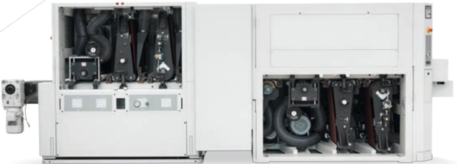
Elle peut être composée d'une machine inférieure ou supérieure ou en ligne de façonnage avec les deux machines unies, ce qui permet d'usiner les deux côtés du panneau en un seul passage.
