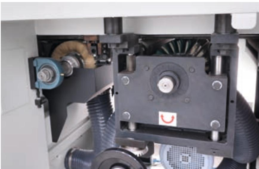
Robuste et fiable, la **brosse longitudinale** est munie du système d'oscillation transversale pour uniformiser la qualité de finition sur l'objet et de réglage d'interférence électronique actionnable depuis le tableau de commande. Les poils abrasifs peuvent être rapidement remplacés sans devoir extraire le groupe de la machine. Brosse à inserts abrasifs de 200 mm de diamètre.
