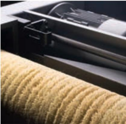
Die **Bürste zum Reinigen der Platte** kann für eine gründliche Reinigung der bearbeiteten Platten mit Borsten aus unterschiedlichem Material ausgestattet werden.
