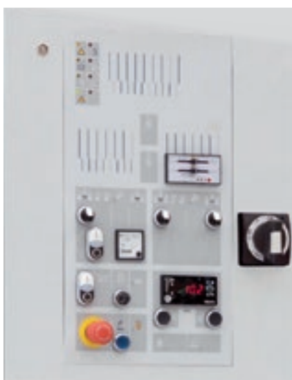
Кнопочная панель управления (стандартная комплектация) позволяет просто и интуитивно управлять функциями станка.
