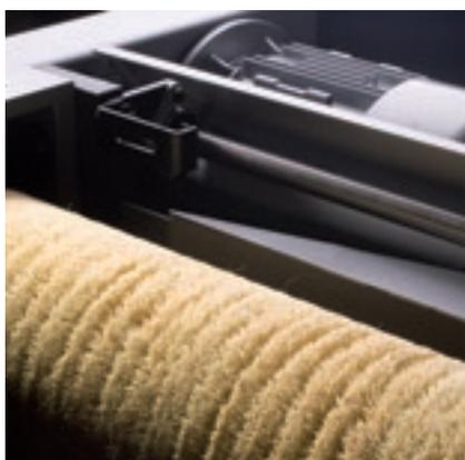
El **cepillo de limpieza del tablero** puede ir dotado de cerdas de varios materiales para limpiar a fondo los tableros mecanizados.
