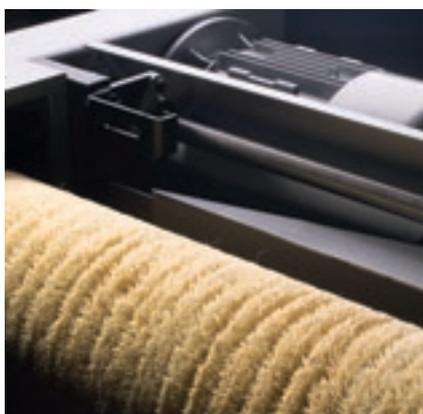
La **brosse de nettoyage du panneau** peut être dotée de poils de différents matériaux pour un nettoyage approfondi des panneaux façonnés.
