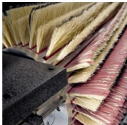
Le **groupe de brossage à inserts abrasifs** peut être muni d'un système d'oscillation transversale pour uniformiser la qualité de finissage du produit. Les poils abrasifs peuvent être rapidement remplacés sans devoir extraire le groupe de la machine.
