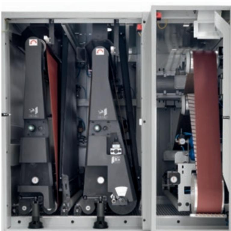
La S2 est la ponceuse-calibreuse capable de loger jusqu'à 3 groupes opérateurs pour assurer une finition optimale des produits et une grande flexibilité de façonnage.
