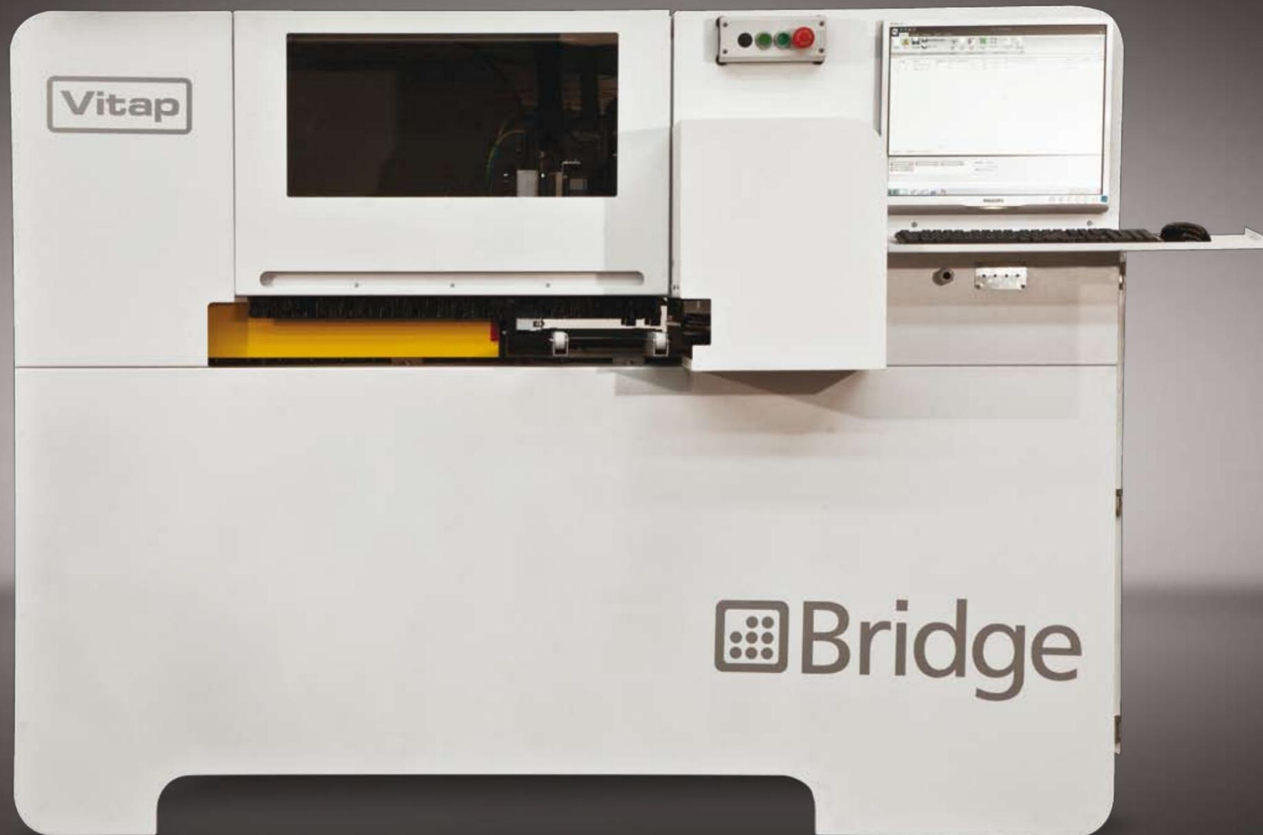
La Bridge rappresenta la più piccola foratrice CNC della gamma Vitap garantendo comunque alte performance ed alta flessibilità. Tempi messa a punto macchina uguali a zero grazie alla movimentazione a pinza completamente automatizzata.
