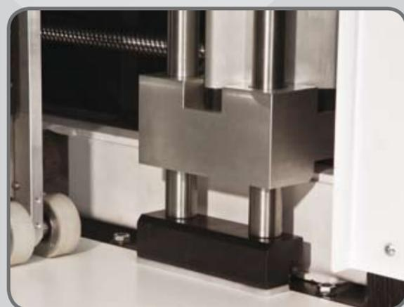
Pinza pneumatica a massimo bloccaggio pannello.
