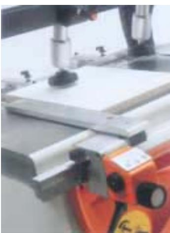
Foratura in verticale e pressore inclinato di 15°.
