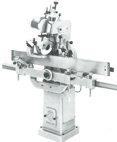
Aufspannwagen mit Teilschienenschaltung bis 1400 mm Verzahnungslänge und Blattbreite bis 140 mm (Cne II 55/N 52), für doppelverzahnte Sägen (Cne II 55/N 52.12) für Blattbreite bis 160 mm (Cne II 55/N 52.13)
