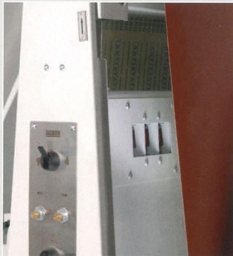
Optische Oszillationssteuerung und Bandablaufsicherung
