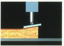
La alta calidad de las superficies se caracteriza por un lijado uniforme y exento de marcas, incluso con formas complicadas, dado el sistema de segmentos flotantes de patín electrónico. La técnica de cilindros de presión con punto de contacto articulado WEBER ISA/ISD garantiza esta calidad.
