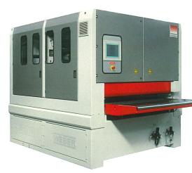
Técnica de lijado con sistema de banda transversal de alta calidad para los más altos requerimientos. De una banda a cuatro bandas con disposición libre de las bandas longitudinales y transversales. Anchos de trabajo: 600 mm, 1100 mm, 1350 mm y 1600 mm. Patín electrónico en la ejecución WEBER ISA/ISD.
