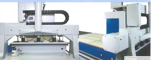
Für Werkstücke oder Schonplatte inklusive Absaugung. Das Ausschieben ist in beide Richtungen möglich.
