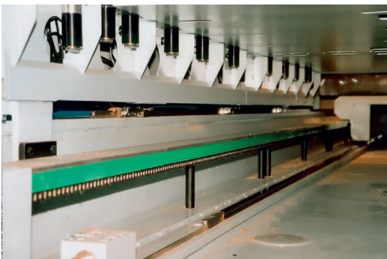
Shuttle-System: Die beiden Arbeitstische sind übereinander angeordnet. Zur Bearbeitung fahren sie mit bis zu 20 m/min in den Arbeitsbereich.
