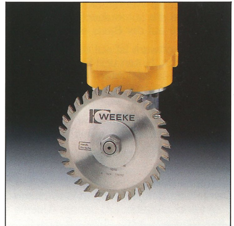
Nutsägeaggregat, Nutsäge 150 mm Ø, für ein- und aussetzende Nutzung in X-Richtung. Alternativ kann eine automatische Schwenkung um 90 Grad (für X/Y-Richtung) eingesetzt werden.
