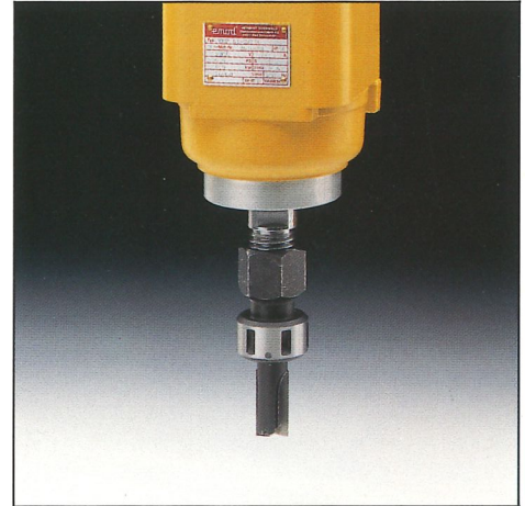
Oberfräs-Aggregat (4,0 kW) mit stufenloser Drehzahlregelung (6000 – 18000 UpM) Werkzeugaufnahme MK 2 oder Spannzange.
