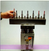
Hydraulisch-pneumatische Bohrschubeinheit mit Bohrgetriebe im 32 mm Raster und Weeke-Schneidstrahlsystem.
