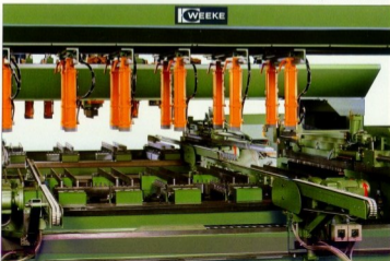
Maschineneinbaueile mit automatischer Transporteinrichtung und Vortransportbahnen.
