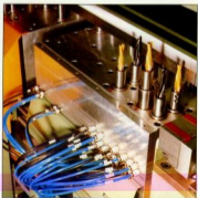
Vertikaler Bohrkopf mit einzelnen abnutzbaren Bohrspindeln, 32 mm Raster. Auf Wunsch andere Raster.
