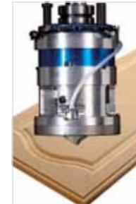
**Getastetes Fräsaggregat mit Tastring**
