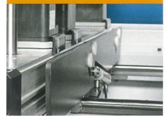
4 robuste Einlegehilfen zum Belegen schwerer Werkstücke
