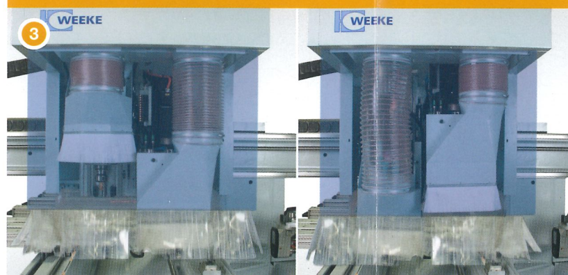
■ Optimale Absaugung und größerer Einsatzbereich für Bearbeitungsaggregate. ■ Gewichtverteilung der Masse (Bearbeitungsaggregate) auf die zwei Z Achsen → mehr Stabilität, höhere Bearbeitungsqualität
