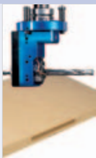
Défonçage boîtiers de serrure*, 2 broches
