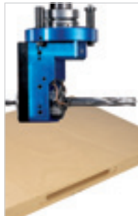
Défonçage* boîtiers de serrure, 2 broches
