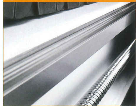
Langlebiges geschlossenes Linearführungssystem
