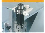
Sicheres und schnelles Beschicken des Werkzeugwechselmagazines
