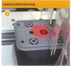
Einfaches Positionieren der Sauger durch den Fadenkreuzlaser
