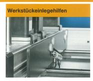
4 robuste Einlegehilfen zum Belegen schwerer Werkstücke
