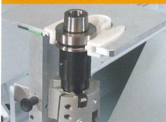
Sicheres und schnelles Beschicken des Werkzeugwechsellagers
