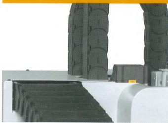
Sichere und geschützte Kabelführung (X-Y-Z)
