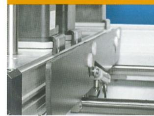
4 robuste Einlegehilfen zum Belegen schwerer Werkstücke
