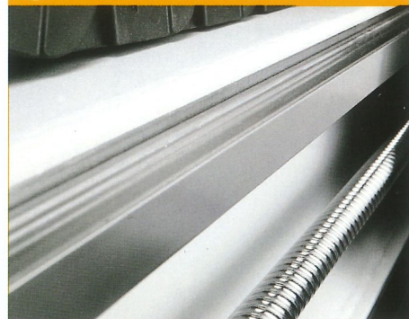
Langlebiges geschlossenes Linearführungssystem
