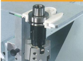
Sicheres und schnelles Beschießen des Werkzeugwechselmagazines
