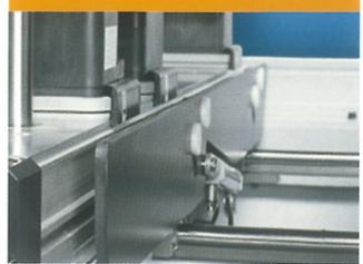
4 robuste Einlegehilfen zum Belegen schwerer Werkstücke
