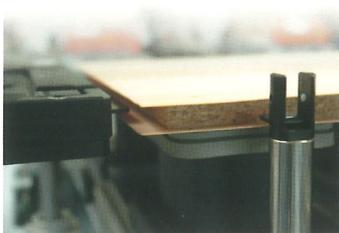
Gewährleistet einfaches Positionieren bei Material mit Furnierüberstand
