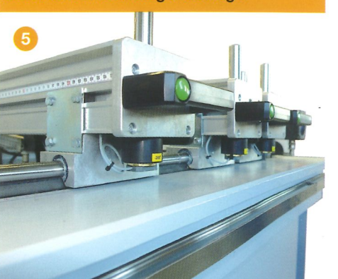
Erhöhte Sicherheit durch eine elektronische Endlagenabfrage an allen vorhandenen Anschlagzylindern
