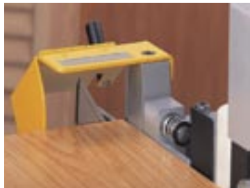
Bündigkappen der überstehenden Kante vorne und hinten.
