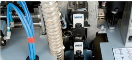
Einfache Einstellung der Fräsmotoren und Kopierschuhe mit Digitalzähler
