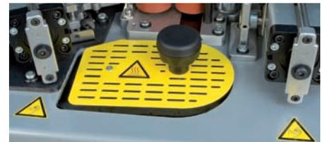
Teflonbeschichtetes Leimbecken mit Einstellmöglichkeit des Leimauftrages
