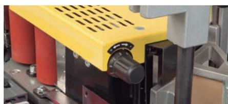
Präzise, einfache und schnelle Leimeinstellung für korrekte Dosierung je nach Material.
