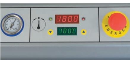
Digitale Einstellung der Arbeitstemperatur. Automatischer Standby-Modus nach 30 Minuten reduziert die Leimtemperatur auf 110°
