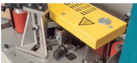
Einfache und schnelle Einstellung der Kantendicke bis zu 3 mm.
