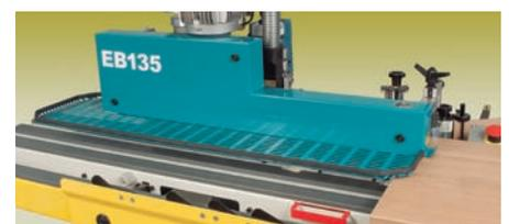
Automatischer Vorschub mit schräg gestellten Einzugsrollen für einen perfekten Durchlauf des Werkstücks.
