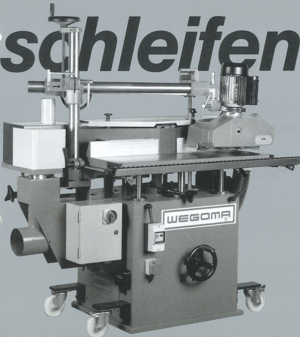
△ Kontakt-Schleifseite mit Vorschubapparat
