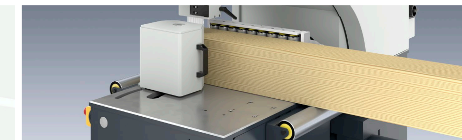
Rodillo de apoyo: facilita la alimentación especialmente de piezas de trabajo largas y pesadas
