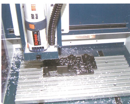
Produzione della dima profilata per l'affilatrice di utensili Weinig.
