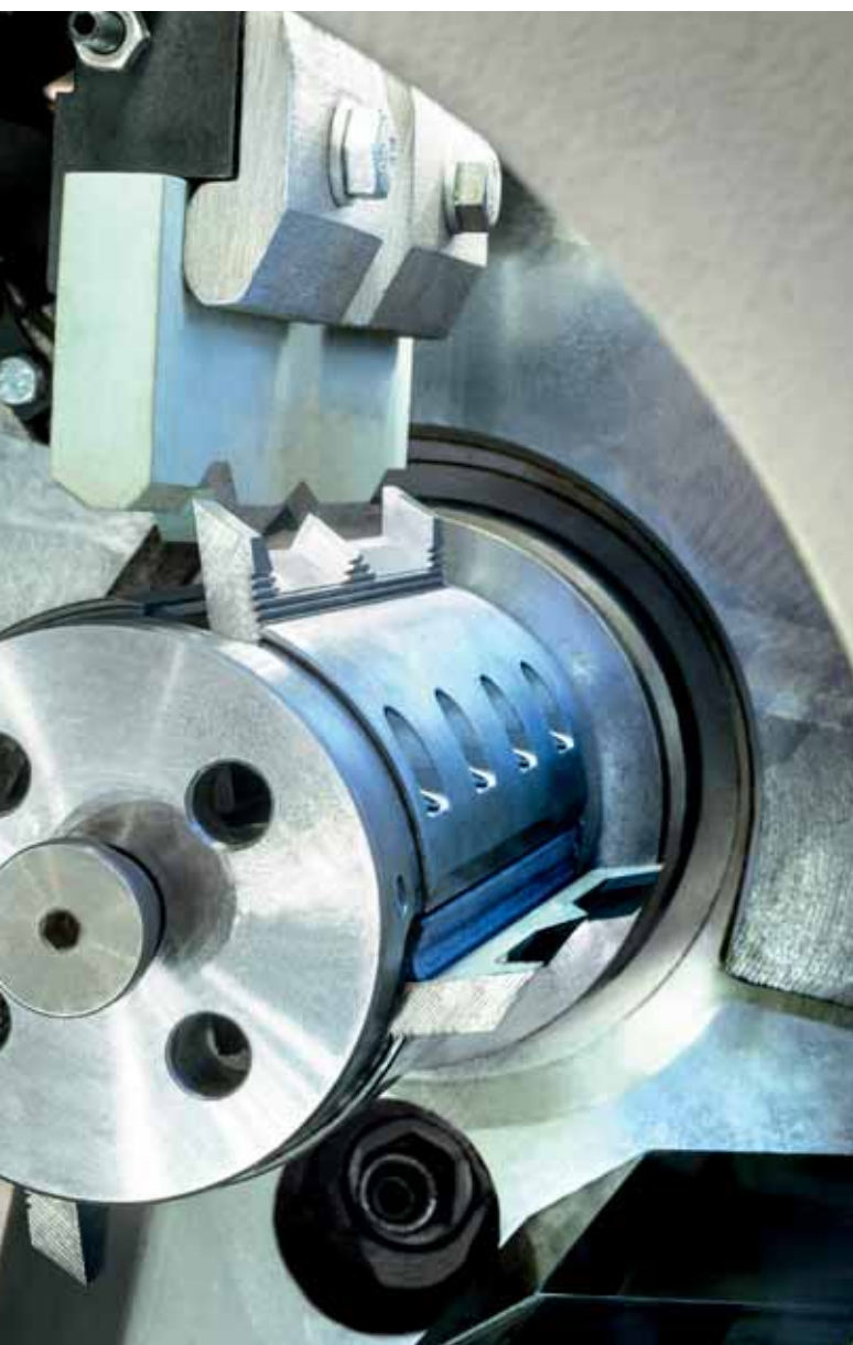
Контропора с осевой регулировочной втулкой Максимальная точность даже при больших размерах и использование гидроинструментов
