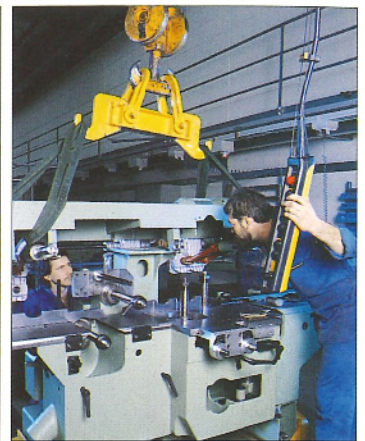
Jetzt kommt der stabile Vorschubbalken dazu.
