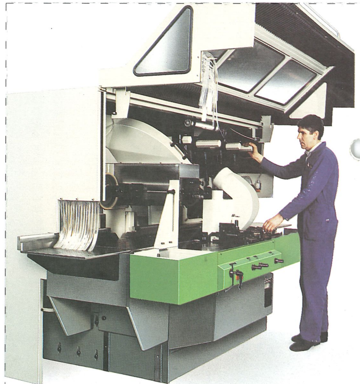
Die Abführung nach der oberen Horizontalspindel ist auf die Werkstückbreite einstellbar. Das Auszugelement besteht aus einer großen Walze über und im Tisch. Beide Walzen sind angetrieben.
