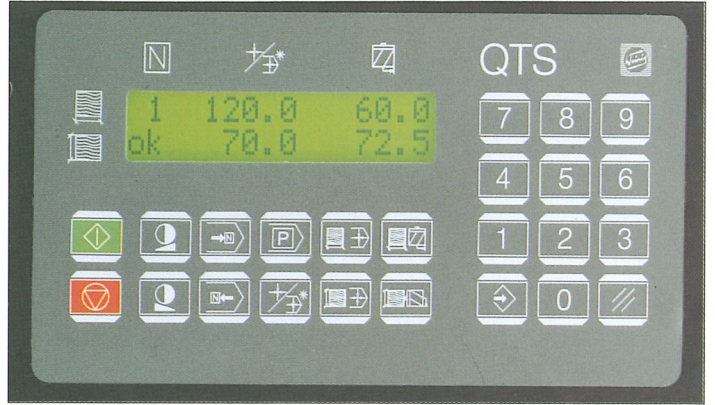
Der Rüstzeitkiller! Der QTS-Computer. Ihre Werkstückdimensionen können Sie einprogrammieren und per Knopfdruck abrufen.
