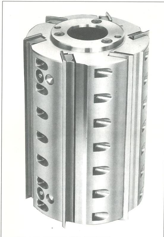
Erst diese hydraulisch zentrisch gespannten Werkzeuge machen hohe Vorschubgeschwindigkeiten bei gleichbleibend hoher Oberflächengüte möglich. Sie sind aus besonders hochfestem Stahl gefertigt. Die extrem niedrige Bohrungstoleranz entspricht derjenigen der Maschinenspindel. Die Zweikammer-Hydrobuchsen garantieren ein spielfreies Klemmen der Werkzeuge. Schneiden aus HSS, Stellite und HM verwendbar.
