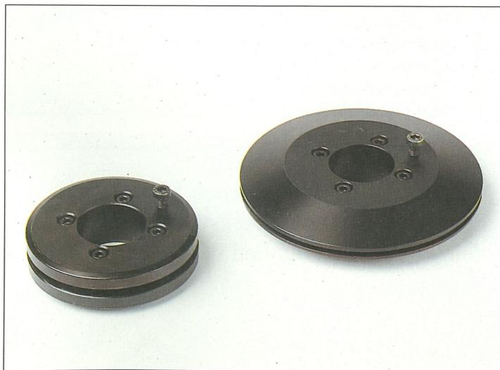
Die Spannflansche benötigen Sie, um die Schleifscheiben in den Weinig Rondamat zu spannen – je 2 für das Schleifen der Profilmesser und für die Hobelmesser.
