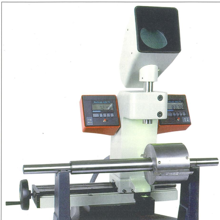
Manuell tragen Sie die Werte in ein Datenetikett ein, das auf das Werkzeug geklebt zur Kehlmaschine gelangt. Mit Hilfe der Werte erfolgt dort die Einstellung der Spindeln.
