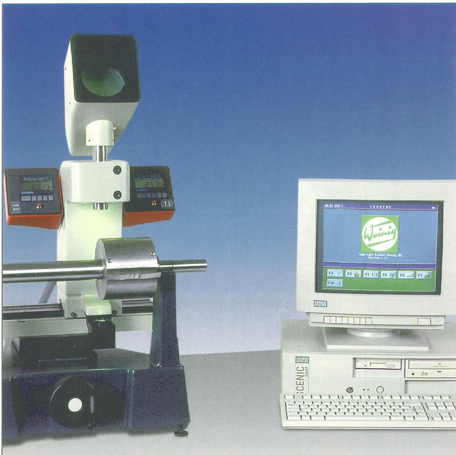
Wer sein Werkzeug vermessen kann, macht den entscheidenden Schritt voran in bezug auf Profilpräzision und Rüstzeitersparnis. Denn sind die Werkzeug- und Profilmaße bekannt, kann die exakte Bearbeitungsposition der Spindeln ermittelt, d. h. errechnet werden.
