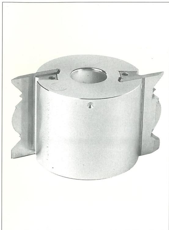
Der Werkzeugkörper ist aus hochfestem Stahl. Die enge Bohrungstoleranz entspricht dem extremen Weinig-Qualitätsstandard. Durch das Weinig-Schnellspannsystem brauchen Sie beim Messerwechsel nur noch je eine Schraube pro Messer zu lösen und anzuziehen. Durch Rückenverzahnung erreichen wir einen absolut sicheren Formschluß. Der Spanwinkel beträgt 20°. Schneiden aus HSS, Stellite oder HM können verwendet werden.
