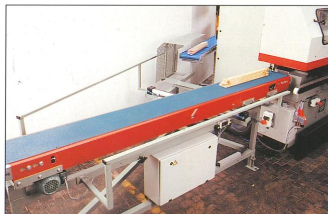
Dreiecks-Rückförderer: Werkstücke werden zum Bediener auf Bearbeitungshöhe zurücktransportiert. Das erspart Ihnen den Mann am Maschinenauslauf.
