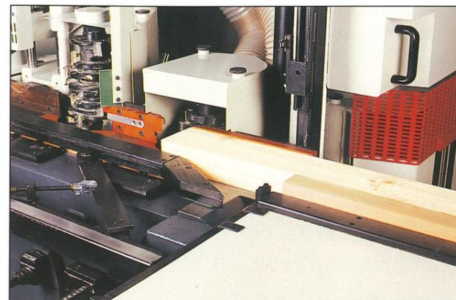
Der Breitenanschlag macht es Ihnen möglich, Hölzer mit bis zu 100 mm unterschiedlicher Breite hintereinander zu bearbeiten, z.B. ein 110 mm breites Setzholz und eine 50 mm breite Sprosse.
