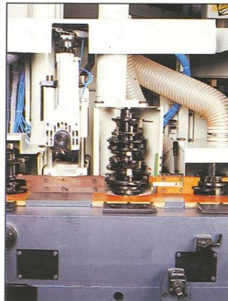
Die Frässpindel ermöglicht die benötigten Werkzeugpositionen.
