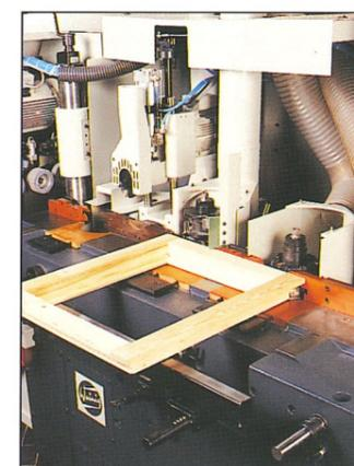
Umfräsen mit einer Gleichlaufspindel. So wird Ihre Weinig Unicontrol 6 zum Umfräseautomat. Getaktete Vorschubwalzen verkürzen die Durchlaufzeit.
