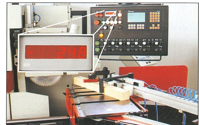
Studiofenster-Einrichtung mit Laser-Richtlicht. Schrägfenster fertigen Sie ohne Aufriß an. Die Informationen der Arbeitsvorbereitung werden direkt umgesetzt. Elektronische Winkelanzeige.
