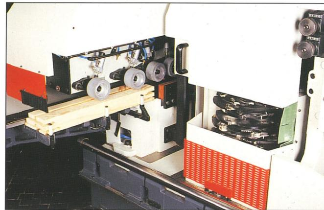
Doppelteile-Paket: Vollautomatisch werden die Werkstücke zur Längsprofilierung übergeben. Und zwar paarweise! (Weinig-Spezialität!)
