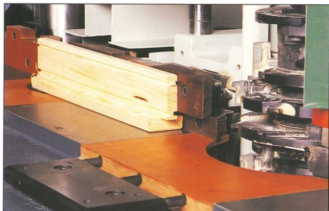
Die Vorschubwalzen haben einen extrem kurzen Abstand. Der Anschlag ist austaktbar. So können auch sehr kurze und schmale Sprossen bearbeitet werden.
