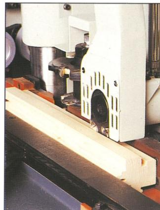
Die Nutspindel fräst auf mm-Bruchteile genau, z.B. die Rolladen-Deckelnut oder den Fensterbank-Anschluß. Wichtig für Altbau-Sanierungen: verschiedene Falztiefen.
