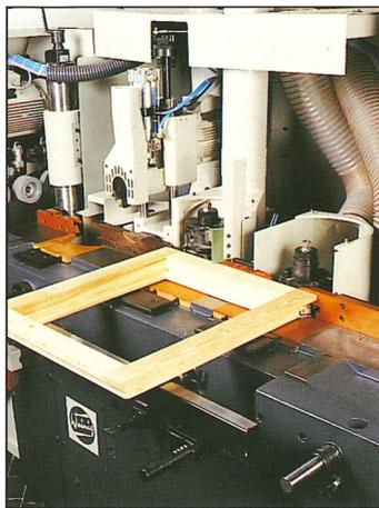
Umfräsen mit einer Gleichlaufspindel. So wird Ihre Weinig Unicontrol 6 zum Umfräsautomat. Getaktete Vorschubwalzen verkürzen die Durchlaufzeit.
