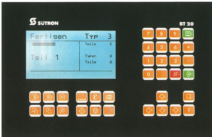
Bildschirmsteuerung: Bis zu 99 Fenstertypen mit jeweils 8 Teilen können Sie frei programmieren. Integrierte Bedienerführung und Fehlerdiagnose über Bildschirm!
