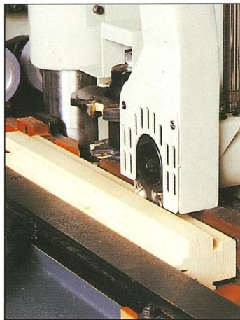
Die Nutspindel fräst auf mm-Bruchteile genau, z.B. die Rolladen-Deckelnut oder den Fensterbank-Anschluß. Wichtig für Altbau-Sanierungen: verschiedene Falztiefen.
