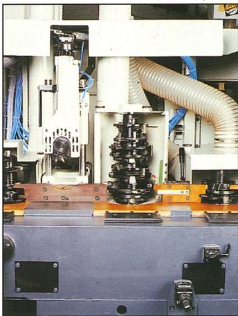
Die Frässpindel ermöglicht die benötigten Werkzeugpositionen.
