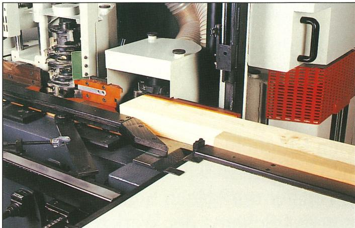
Der Breitenanschlag macht es Ihnen möglich, Hölzer mit bis zu 100 mm unterschiedlicher Breite hintereinander zu bearbeiten, z.B. ein 110 mm breites Setzholz und eine 50 mm breite Sprosse.
