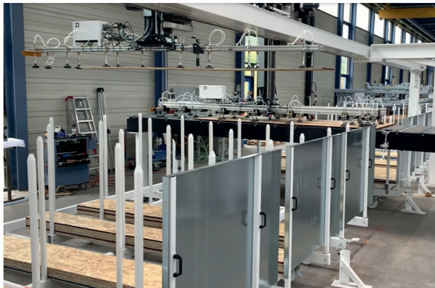
Effizientes Plattenhandling Vollautomatisches Beschickungsportal für Plattenmaterialien
