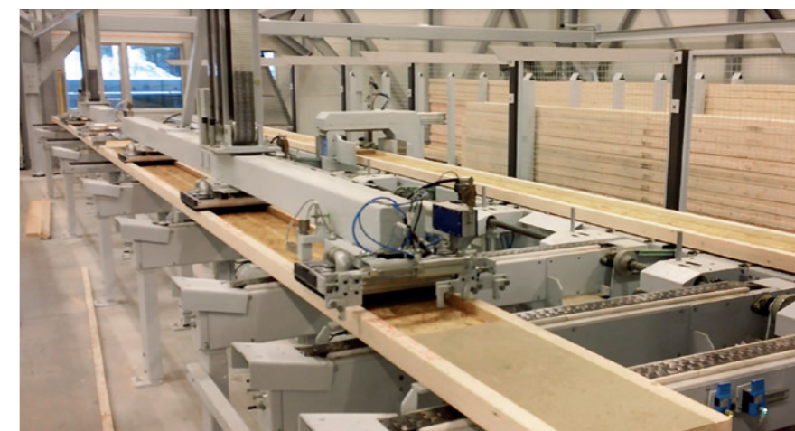
Vielseitige Stielezufuhr Flächenportal für die Stieleschickung mit integrierter Sortiereinheit
