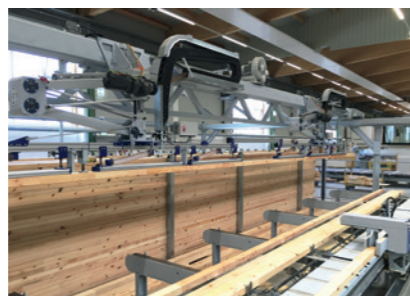
Leistungsstark und flexibel Abbundanlage mit Beschickungsportal und integriertem Lager
