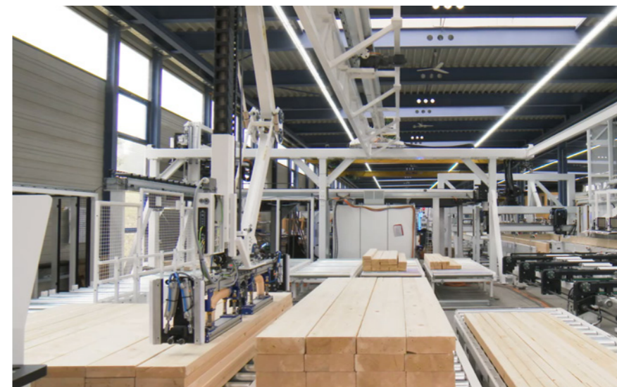
Vielseitige Stielezufuhr Flächenportal für die Stieleschickung mit integrierter Sortiereinheit
