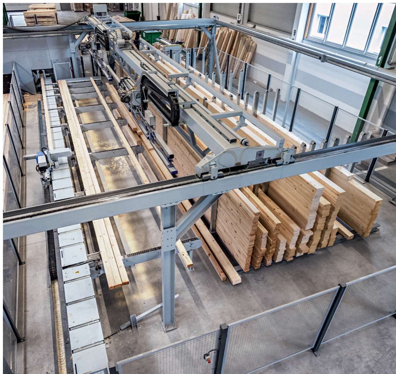
Leistungsstark und flexibel Abbundanlage mit Beschickungsportal und integriertem Lager
