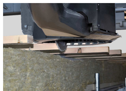
Formatage des lattes de toit
