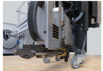
Fixation du revêtement
