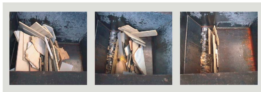
Arbeitsweise der Schublade, Andrücken des Materials gegen den Rotor
