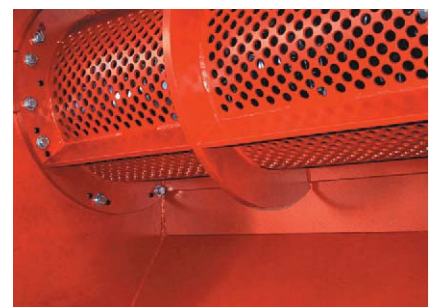
Der Siebloch-Durchmesser (10-100 mm) bestimmt die Schnitzelgröße
