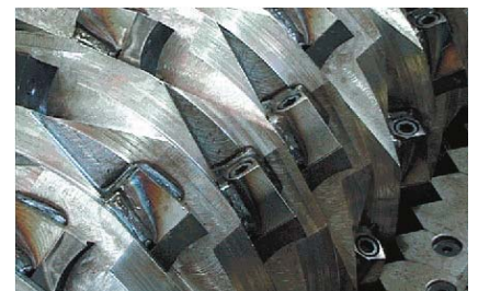
V-Rotor mit zwei Messerreihen
