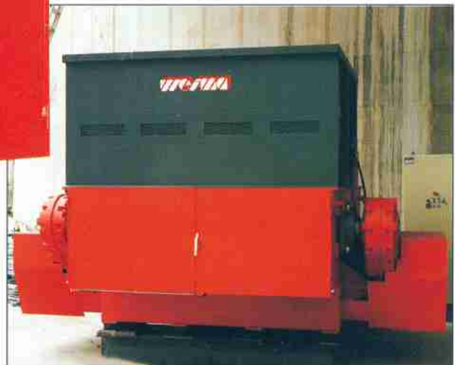
WL Super-Jumbo 22 mit 2 x 75 kW-Antrieb
